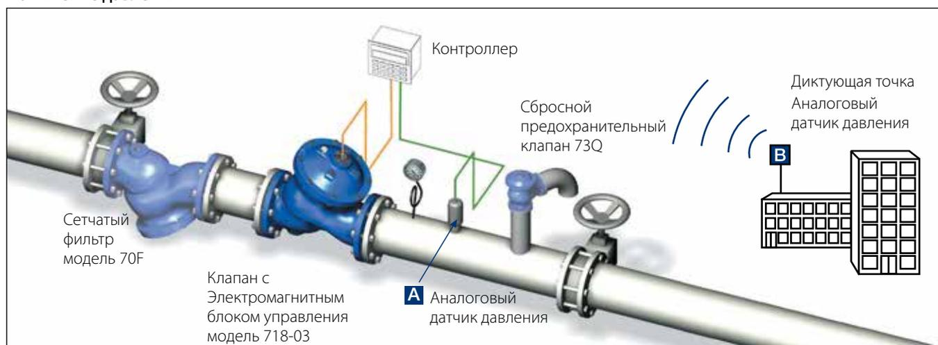
Установка датчика давления на выходе клапана позволяет обеспечить функцию понижения давления.
