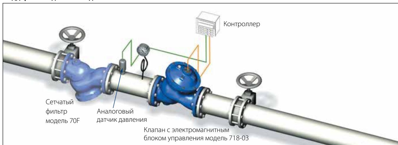
Установка датчика давления на входе клапана позволяет обеспечить функцию поддержания давления «до себя»:
