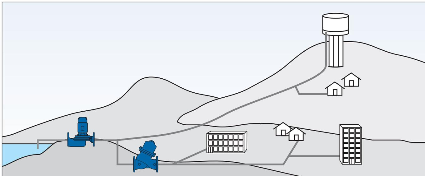
Насосная станция подает воду в распределительную сеть и в резервуар.
