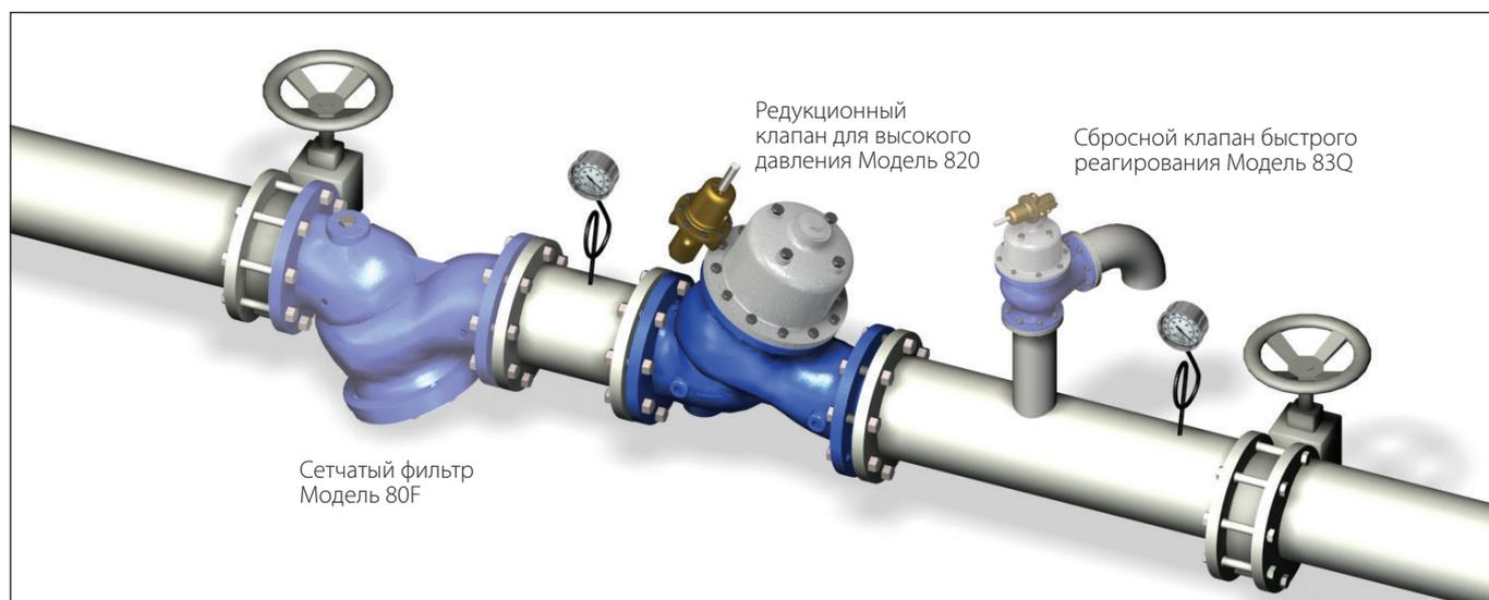
Дополнительно к редукционному клапану высокого давления модели 820, рекомендуется установить:
