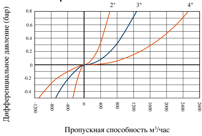
График пропускной способности клапана в кинетическом режиме
